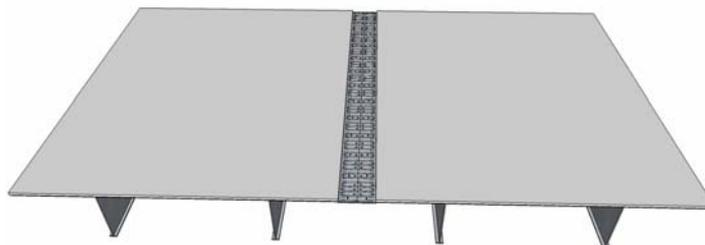
图 6.2.5 STC 接缝应设于低应力区
